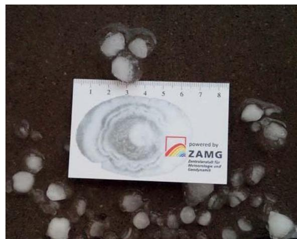
Abb. 6: Wettermelden mit Hilfe wasserfester Kärtchen mit Zentimeterskala
