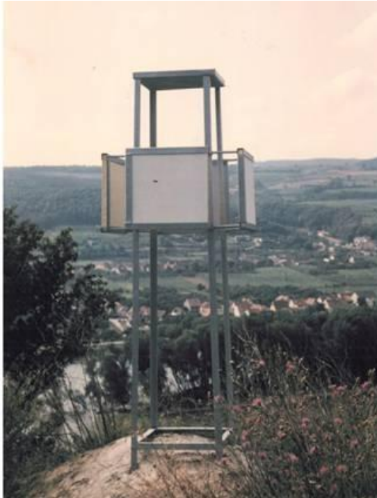
Abbildung AP 3.4.1: HTP-Station im Raum Gleisdorf-Weiz mit vier nach den Himmelsrichtungen ausgerichteten, vertikal befestigten Platten und einer Deckplatte. Quelle: Otto Svabik
